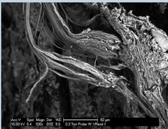
Bild 9 ESEM-REM-Aufnahme von stark gebundenen Asbestfasern in der Bruchfläche einer zementgebundenen Kunstschieferplatte [C.4]
